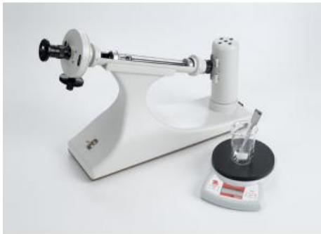
Dans l'expérience P5.4.3.4, il sagit de mesurer des concentrations de sucre à laide dun polarimètre de type commercial et de les comparer avec les valeurs mesurées lors des expériences.
