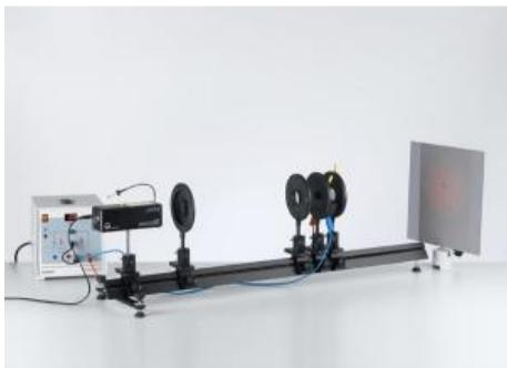
Dans l'expérience P5.4.5.1, on démontre leffet Pockels sur un cristal de niobate de lithium placé dans le trajet conoscopique dun faisceau lumineux.
