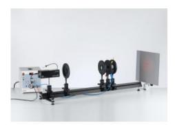
P5.4.5.1 Démonstration de l'effet Pockels dans un trajet conoscopique du faisceau lumineux
