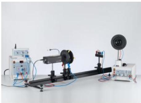
Dans l'expérience P5.4.5.2, on présente l'application de la cellule de Pockels pour la transmission de signaux à fréquences vocales.
