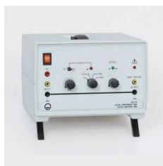
Amplificateur de mesure universel de la tension alternative et continue avec étage de puissance.
