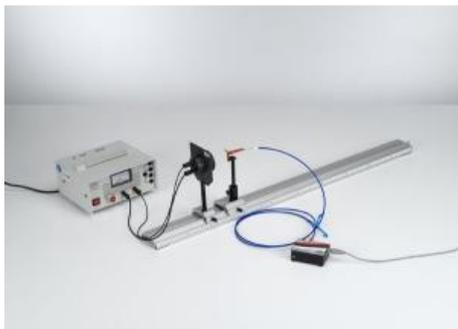
Dans l'expérience P5.5.2.4, un conducteur électrique d'une lampe à incandescence est chauffé à l'aide du courant électrique jusqu'à incandescence.
