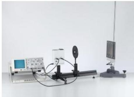
Dans l'expérience P5.6.2.1, on varie la distance parcourue par les impulsions lumineuses puis on mesure le changement du temps de propagation avec un oscilloscope.
