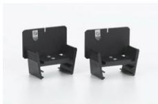
Le butoir est fixé sur le rail ( 337 130 ) ou un rail avec des voies écartées de 45 mm. Il délimite la distance parcourue par un chariot sur le rail. Par ailleurs, il est doté d'un porte-ficelle qui sert à tendre des ressorts au moyen d'une corde fine.
