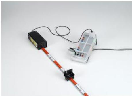
Dans l'expérience P5.6.3.3, le capteur de déplacement à laser S sert à mesurer directement le temps de propagation  $t$ .
