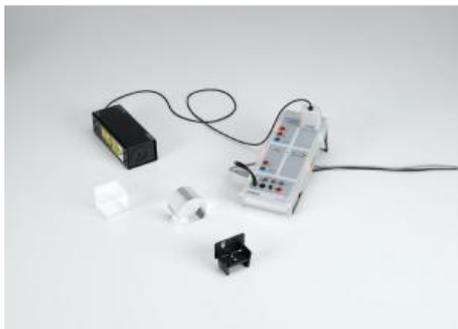
Dans l'expérience P5.6.3.4 on place de l'eau et du plexiglas d'épaisseur  $d$  dans la marche des rayons pour ensuite mesurer l'augmentation du temps de propagation ainsi obtenue.
