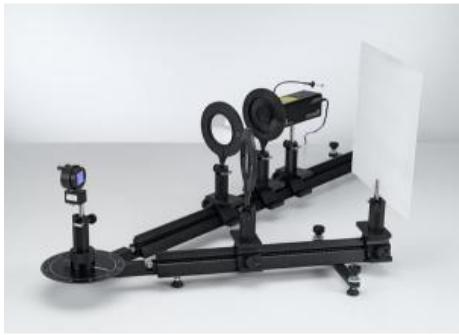
Dans l'expérience P5.7.2.4, la constante du réseau de réflexion holographique est déterminée avec différents angles d'incidences.
