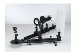
P5.7.2.4 Détermination de la constante du réseau holographique à l'aide d'un laser He-Ne
