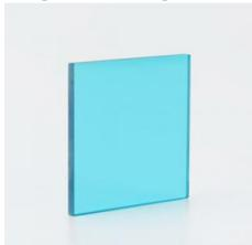
Le filtre de lumière vert BG39 bloque le rayonnement d'un laser (de pompage) au-dessus de 800 nm et laisse le rayonnement visible à 532 nm par avec 80% efficiency. Le filtre est utilisé dans un diode laser à semi-conducteurs pour séparer le second harmonique à 532 nm du rayonnement laser et de la pompe.
