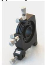
Support ajustable, respectivement déplaçable et basculable sur deux axes.
