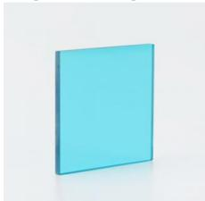
Le filtre de lumière vert BG39 bloque le rayonnement d'un laser (de pompage) au-dessus de 800 nm et laisse le rayonnement visible à 532 nm par avec 80% efficiency. Le filtre est utilisé dans un diode laser à semi-conducteurs pour séparer le second harmonique à 532 nm du rayonnement laser et de la pompe.
