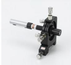
Pointeur laser vert dans support pour l'ajustage, par exemple du tube laser HeNe 474127 .
