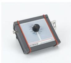
Pour l'envoi d'une décharge électrique dans le gaz d'un laser hélium-néon avec courant réglable et impulsions d'allumage.
