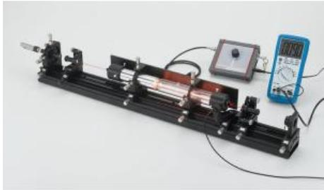
L'expérience P5.8.5.5 consiste à réaliser un laser hélium-néon constitué des éléments de base. La cavité en configuration ouverte permet de modifier les paramètres pour mesurer le profil du faisceau pour différentes configurations et distances des miroirs de la cavité.
