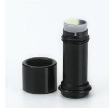
Miroir concave pour la réalisation d'un résonateur laser à 1064 nm, avec 4745310 .
