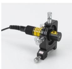
Diode laser sans autre composant optique, montée sur un support basculable et pouvant être déplacé transversalement.
