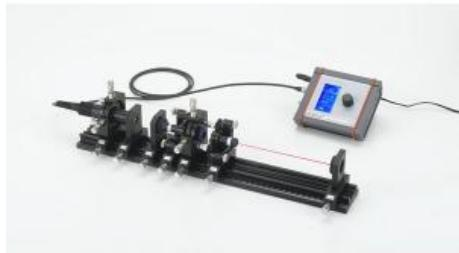
L'expérience P5.8.6.4 est une variante de l'expérience P5.8.6.3 mais en utilisant différents miroirs traités et différents orientations de coupe du cristal de KTP, le laser Nd:YA fonctionne à 1320 nm et la lumière visible doublée en fréquence est rouge à une longueur d'onde de 660 nm.
