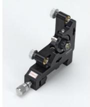
Lentille aphérique de collimation dans support ajustable. Avec connecteur ST.
