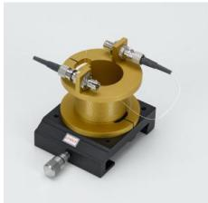
Ce module est la pièce maîtresse de l'installation et l'un des composants les plus précieux. Il se compose d'une fibre dopée à l'erbium de 2 m, enroulée sur un tambour. Les extrémités de la fibre sont reliées à des connecteurs ST qui sont eux-mêmes reliés à la prise de fibre.
