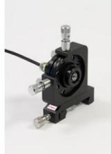
Laser à diode rouge à luminosité réglable. Le laser est décalé latéralement afin de générer avec le séparateur de faisceau 474187 deux faisceaux symétriques, par exemple pour une anémométrie laser Doppler. Dispositif d'ajustage X,Y - ?, f pour l'orientation du faisceau inclus.
