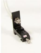
Buse de sortie de la brume produite par le nébuliseur 474315 .
