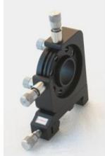
Support ajustable, respectivement déplaçable et basculable sur deux axes.
