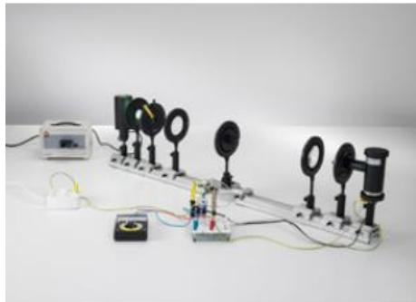
Pour l'expérience P6.1.4.2, on choisit un montage ouvert sur le banc optique. La décomposition de la longueur d'onde est effectuée avec un prisme à vision directe. A chaque fois, la lumière rencontre précisément une raie spectrale à la cathode de la cellule photoélectrique.
