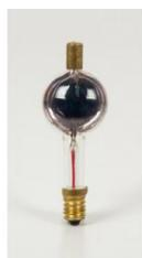
Pour la mise en évidence de l'effet photo-électrique à la lumière visible, pour l'étude de l'influence de la fréquence sur le courant photo-électrique et essentiellement pour la détermination de la constante de Planck par la méthode du courant d'opposition.
