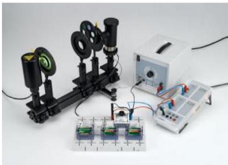
Au cours de l'expérience P6.1.4.4 on sélectionne une des raies de la lumière d'une lampe à mercure à l'aide de filtres interférentiels pour la représenter à la cathode de la cellule photo-électrique.
