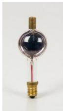
Pour la mise en évidence de l'effet photo-électrique à la lumière visible, pour l'étude de l'influence de la fréquence sur le courant photo-électrique et essentiellement pour la détermination de la constante de Planck par la méthode du courant d'opposition.
