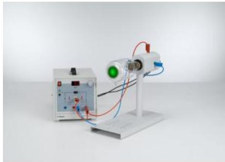
La diffraction délectrons par du graphite polycristallin est démontrée au cours de l'expérience P6.1.5.1.
