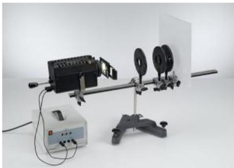
Dans l'expérience P6.1.5.2, on illustre la méthode de Debye et Scherrer appliquée à un tube pour la diffraction d'électrons avec de la lumière visible.
