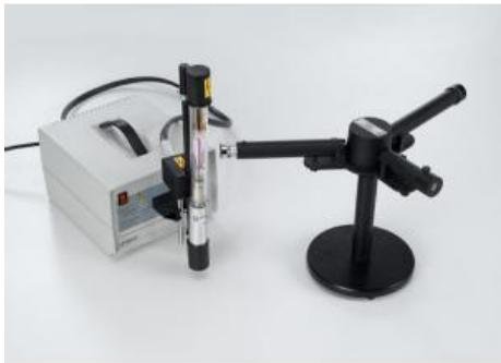
Dans l'expérience P6.2.1.2, la série de Balmer est observée à l'aide d'un spectromètre à prisme (système complet).
