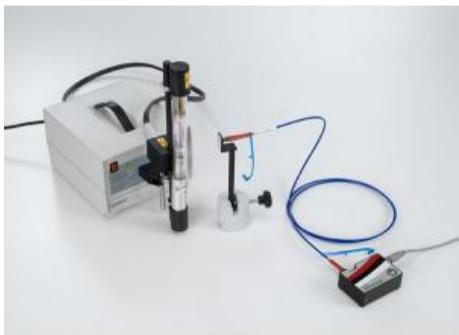
Dans l'expérience P6.2.1.4, la série de Balmer de l'hydrogène est étudiée sur PC à l'aide d'un spectromètre compact.
