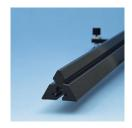
Pour démonstrations et expériences en laboratoire nécessitant une grande précision. Profilé triangulaire, avec pied et vis de réglage pour ajustage en trois points Extrémités pourvues d'alésages permettant la fixation d'éléments de jonction pour d'autres rails.
