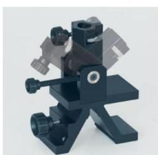
Cavalier pour banc d'optique à profil normalisé. Pour démonstrations et expériences en laboratoire de haute précision. Profilé d'aluminium anodisé noir, traité mécaniquement pour une grande précision. Pour les composants optiques dans monture avec tige. Permet de faire basculer les composants optiques en dehors de l'axe optique.
