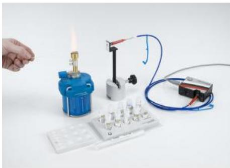
Dans l'expérience P6.2.2.4, les colorations des flammes par des sels métalliques sont étudiées. Un spectromètre compacte connecté à un ordinateur par cable USB permet un enregistrement simple des processus transitoires et l'analyse de raies apparentes. Contrairement à une observation classique à l'œil, les raies sont également visibles dans le domaine infrarouge, par exemple le potassium.
