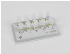
Pour des observations spectroscopiques ; sels métalliques permettant l'identification de substances par la coloration caractéristique d'une flamme. Les sels sont conditionnés dans des petits tubes fermés, clairement disposés sur un plateau.
