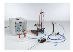
P6.2.2.6 Enregistrement de spectres de lampes à décharge de gaz à l?aide d?un spectromètre compact
