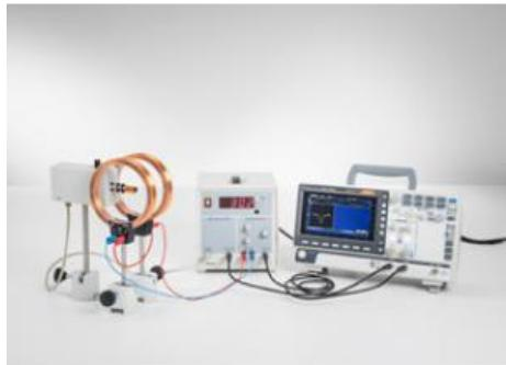
Durant l'expérience P6.2.6.2, on met en évidence la résonance de spin électronique avec du diphénylpicrylhydrazyle (DPPH).
