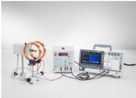
Durant l'expérience P6.2.6.2, on met en évidence la résonance de spin électronique avec du diphénylpicrylhydrazyle (DPPH).
