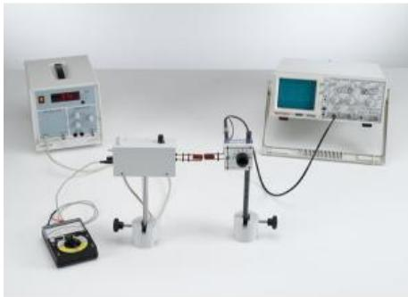
L'objet de l'expérience P6.2.6.3 est la mise en évidence de l'absorption résonnante avec un circuit oscillant passif.
