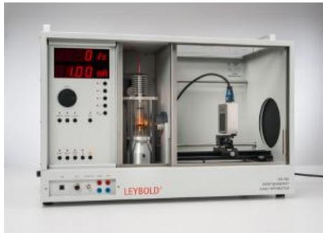
Dans l'expérience P6.3.2.4, il s'agit de mesurer l'intensité du rayonnement X à une distance variable du tube à rayons X.
