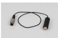
Tube compteur Geiger-Müller à auto-extinction, dans boîtier en plastique, avec fenêtre en mica très mince permettant aussi l'enregistrement d'un rayonnement β mou. Muni d'un câble solidaire. Livré avec capuchon de protection pour la fenêtre en mica.
