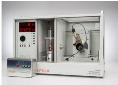
Dans les expériences P6.3.6.12 et P6.3.6.13, on étudie le rayonnement caractéristique de basse énergie de l'anode en cuivre et de l'anode en fer et on mesure la fine structure à haute résolution de la raie K $\alpha$ .
