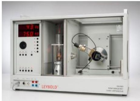
L'expérience P6.3.6.3 porte sur l'analyse du rayonnement à énergie basse caractéristique de l'anode en fer et la mesure de la structure fine de la raie K $\alpha$ .
