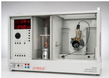
L'expérience P6.3.6.6 pour la mesure directe de la fission de la couche L, est un supplément à P6.3.6.5. On excite d'abord seulement la sous-couche L3 sous tension accélération modérée, les sous-couches L2 et plus tard L1 et leurs raies sont ajoutées à des tensions plus hautes. Ceci permet la mesure directe de l'énergie des différentes sous-couches L.
