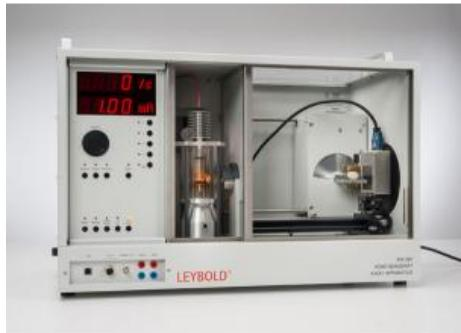
L'expérience P6.3.8.11 est consacrée aux notions de base de la tomodensitométrie (TDM) ou scanographie ainsi qu'à l'enregistrement et à la représentation des tomogrammes d'objets géométriques simples.
