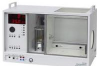
Appareil de base, ajusté et prêt à l'emploi pour tous les tubes Molybdène( 554 861 ) Cuivre( 554 862 ) Fer( 554 863 ) Tungstène( 554 864 ) Argent( 554 865 ), mais livré sans tube et sans goniomètre ( 554 831 ).
