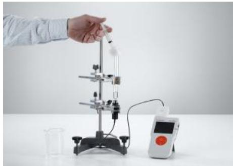
Pour déterminer la demi-vie du Ba-137m dans l'expérience P6.4.3.3, on utilise une bouteille en plastique contenant du Cs-137 conservé au sel.
