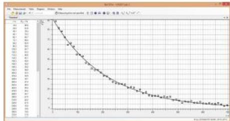
Dans l'expérience P6.4.3.4, on utilise une bouteille en plastique contenant du Cs-137 radioactif. Le Cs-137 se décompose continuellement en Ba-137m.
