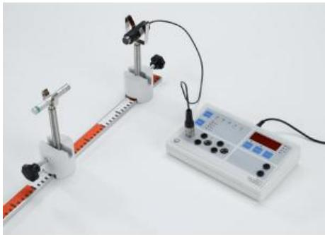
A des fins de comparaison, on enlève l'absorbeur lors de l'expérience P6.4.4.3 et on fait varier l'écart entre la préparation radioactive  $\alpha$  et le tube compteur.
