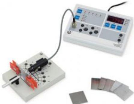
Dans l'expérience P6.4.4.4, on étudie l'atténuation d'un rayonnement  $\alpha$  au passage dans de la matière. Ici aussi, l'intensité diminue quasiment de façon exponentielle.
