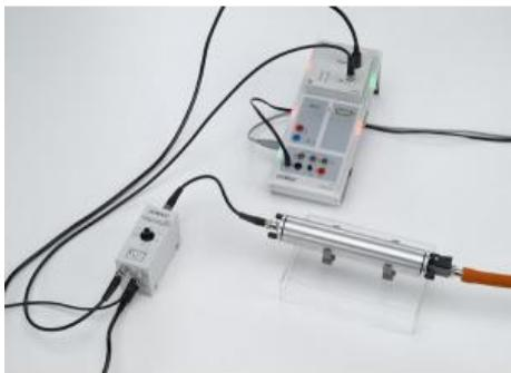
Au cours de l'expérience P6.5.4.2, on mesure l'énergie E de particules alpha en fonction de la pression p de l'air dans la chambre à vide.
