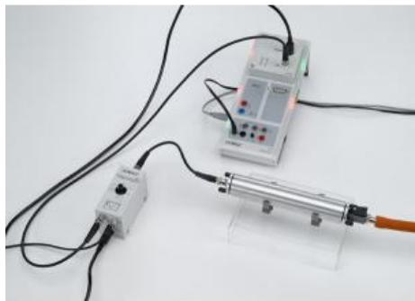
Durant l'expérience P6.5.4.4, on analyse les diverses contributions de la chaîne de désintégration du Ra-226 au spectre dénergie à, pour déterminer l'âge de la préparation radioactive de Ra-226 utilisée.
