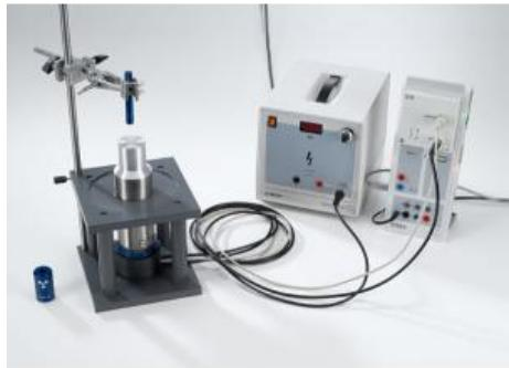
Le relevé et la comparaison de spectres dénergie à de préparations radioactives standard font l'objet de l'expérience P6.5.5.2.
