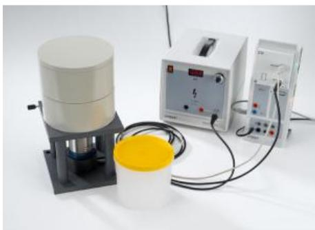
Au cours de l'expérience P6.5.5.4, on utilise un bécher de Marinelli pour mesurer des échantillons faiblement contaminés.
