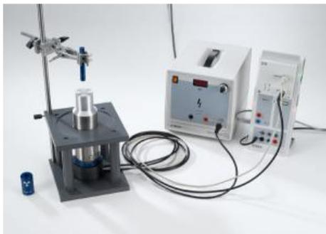
Durant l'expérience P6.5.5.5, on relève à l'aide du compteur à scintillations le spectre continu d'un émetteur pur de rayonnement  $\beta$  ( $^{90}\text{Sr}/^{90}\text{Y}$ ).
