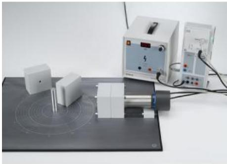
Durant l'expérience P6.5.6.1, on étudie la diffusion Compton de quanta à dénergie  $E_0 = 667$  keV sur les électrons quasiment libres dun diffuseur en aluminium.
