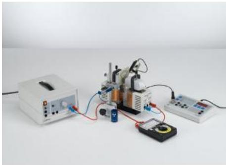
L'expérience P6.5.7.1 consiste à dévier le rayonnement  $\beta$  dans un champ magnétique variable et à relever la distribution angulaire ainsi résultante.
