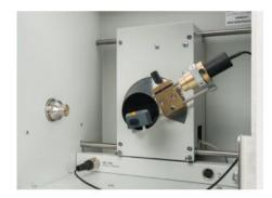
P7.1.2.1 Réflexion de Bragg: détermination de la constante de réseau d'un monocristal
