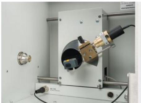
Dans l'expérience P7.1.2.1, on utilise la réflexion de Bragg d'un rayonnement K $\alpha$  du molybdène ( $\bar{a} = 71,080 \text{ pm}$ ) sur des monocristaux de NaCl et de LiF pour déterminer la constante du réseau.
