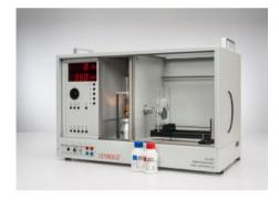
Dans l'expérience P7.1.2.2, le rayonnement de freinage du tube à rayons X joue le rôle de rayonnement X «blanc» afin de réaliser un cliché de Laue des monocristaux de NaCl et de LiF.
