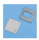
Pour presser une poudre cristalline et relever ensuite les spectres de diffraction des rayons X sur des échantillons de poudre dans l'appareil à rayons X (554 801).
