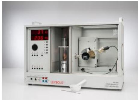
Analogiquement à l'expérience P7.1.2.4, l'expérience P7.1.2.3 utilise pour la représentation des maximums de l'intensité un tube compteur Geiger-Müller au lieu d'un film pour rayon X.
