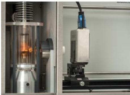
Dans l'expérience P7.1.2.5, le rayonnement de freinage du tube à rayons X joue le rôle de rayonnement X « blanc » afin de réaliser un cliché de Laue des monocristaux de NaCl et de LiF.
