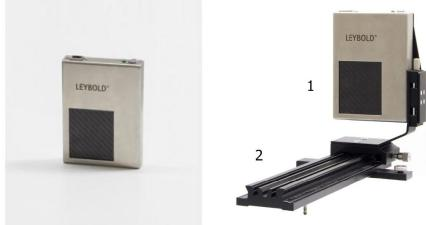
Capteur d'image compacte à haute résolution avec connexion Ethernet pour la prise directe de radiographies dans un appareil à rayons X sous des conditions d'éclairage naturel (sans film radiographique ou écran luminescent).
