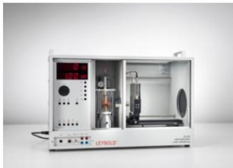
Dans l'expérience P7.1.2.6, des échantillons de fine poudre de cristal micro granulaire sont irradiés avec le rayonnement K $\alpha$  du molybdène pour obtenir un enregistrement par la méthode de Debye-Scherrer.
